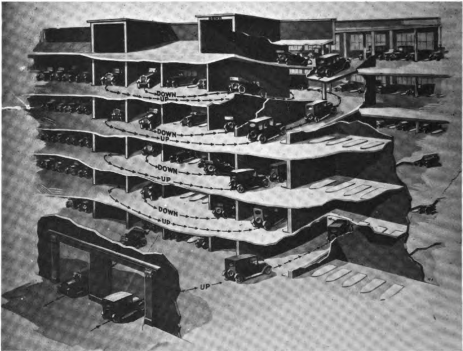
THE D'HUMY MOTORAMP SYSTEM FOR GARAGES
